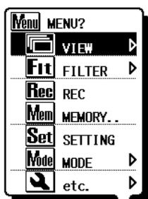
使用 **UP/DOWN** 键或 **转换开关** 移动选择光标，按 **ENTER** 键确认。显示菜单状态中，按 **ESC** 键 关闭菜单窗口。
