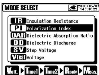
使用 UP/DOWN 键或旋转开关移动光标。按 ENTER 键确认模式。LCD 底部显示各测试模式的设定~开始测试的流程。
