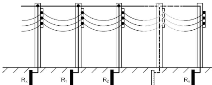
这些接地电阻中,可看成 $R_1$ 、 $R_2$ 、 $R_3$ 、 $R_n$ 全部并联,作为一个合成电阻 $R_s$ ,由于是几个电阻并列连接而形成的合成电阻,与 $R_x$ 相比, $R_s$ 可示为十分小的数值。下图是等价电路图。
