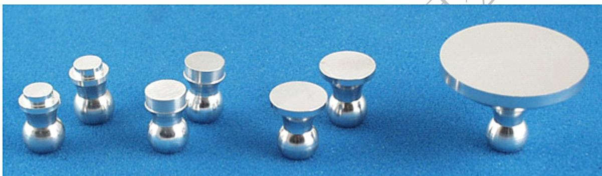
在與可選的 *PosiTest* 50 毫米的配件包非常適合測量低拉脫在 500 psi 的優勢（3.5 兆帕），如塗料在水泥地上。配套工具包包括 50 毫米的推車是最標準的測試規範，涉及的拉伸粘結強度的混凝土塗層。當測試具體，有凝聚力的典型故障的具體範圍內，而不是與塗層和混凝土。通過適當的切割小車周圍，該儀器可用於測量無塗層的拉伸強度混凝土，以及具體的維修。
